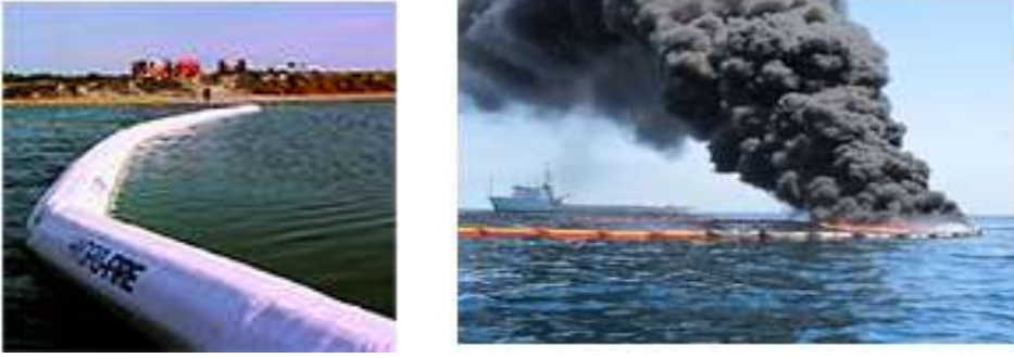
Resim 2.6: Yangın bariyeri ve kullanılışı
