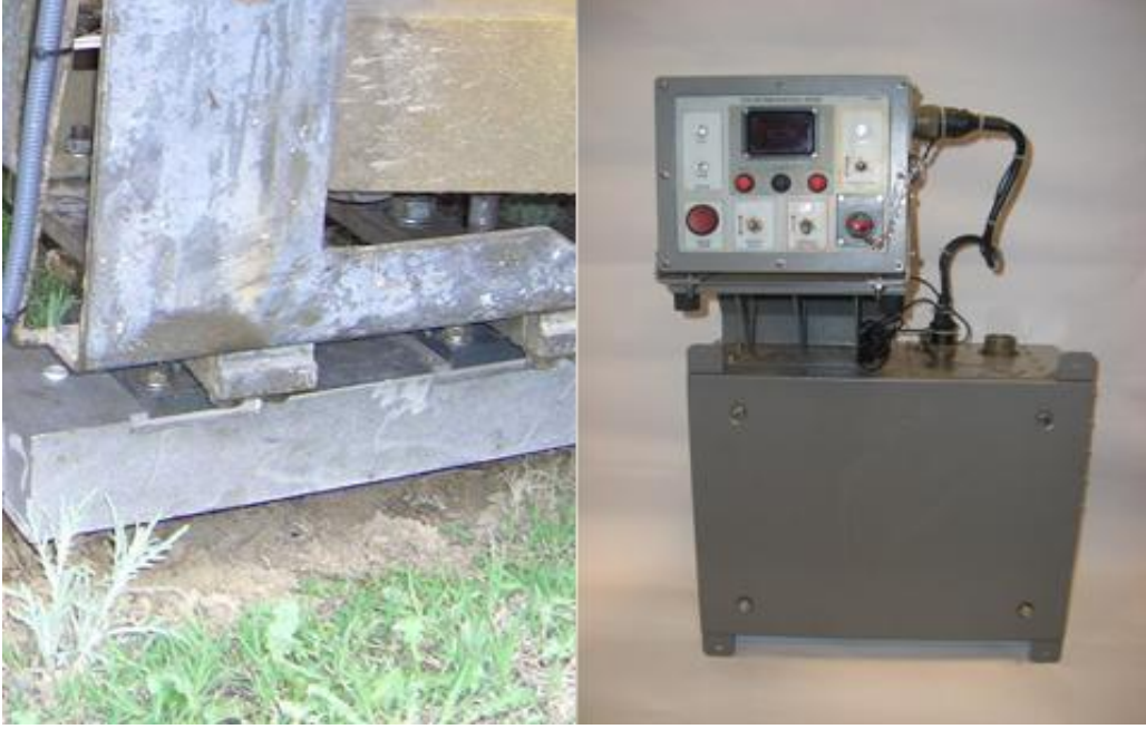
Resim 1.24: Otomatik tren durdurma (ATS) sistemi
