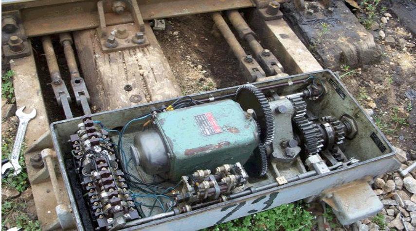
Resim 1.15: Westinghouse tipi bir makas motorunun iç görünüşü resim
