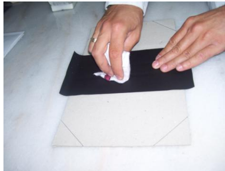
Resim 2.8: Yarım sırt cilt bezinin yapıştırılması
