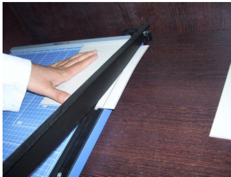
Resim 2.2: Mukavva kesim işlemi
