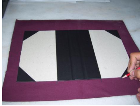
Resim 2.13: İkincil cilt bezinin ölçülendirilmesi
