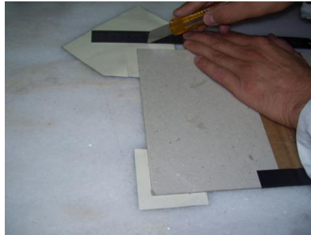
Resim 2.11: Yarım köşelerin kesilmesi
