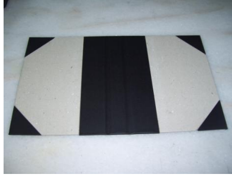
Resim 2.12: Yarım köşelerin yapıştırılması
