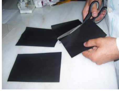
Resim 2.9: Yarım köşe cilt bezlerinin hazırlanması
