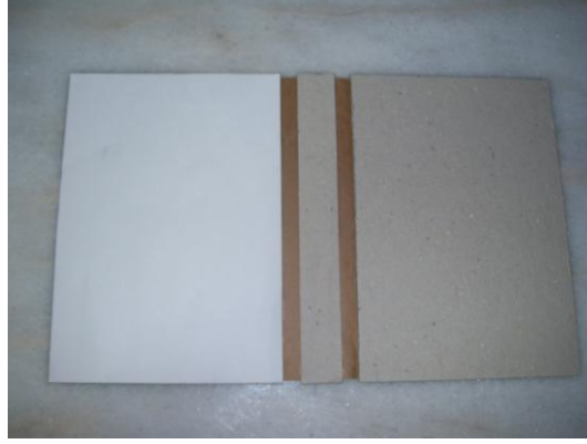
Resim 1.4: Cep kâğıdının mukavvaya yapıştırılması
