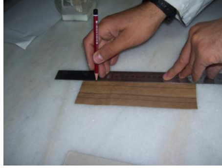
Resim 2.3: Yapıştırma kâğıdının işaretlenmesi
