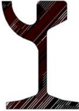
Şekil 1.1: Oluklu ray kesiti Şekil 1.2: Çift mantarlı ray kesiti Şekil 1.3: Patenli ray kesiti
