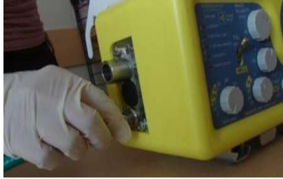
Resim 4.4: Oksijen hattı ile ventilatörün bağlantısını sağlama
