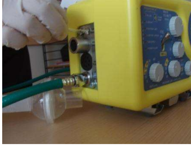
Resim 4.6: Ventilatör ile sensör bağlantısı yapma
