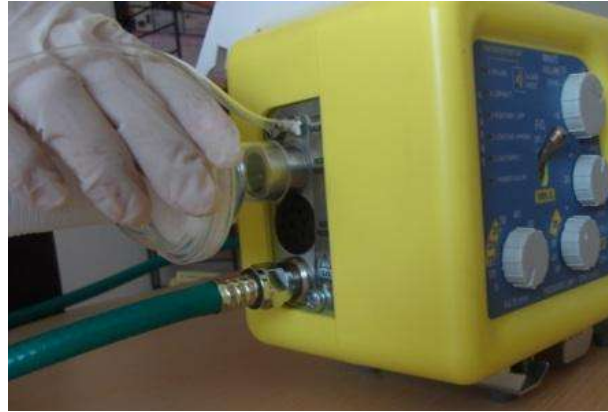
Resim 4.7: Ventilatör ile ventilatör setinin bağlantısını yapma
