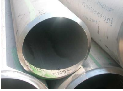
Resim 1.3: V Kaynak ağzı (Talaşlı imalat)
