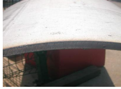
Resim 1.4: Düz kesim (Plazma kesim)
