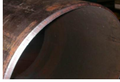
Resim 1.6: V kaynak ağzı (Alevle kesim)
