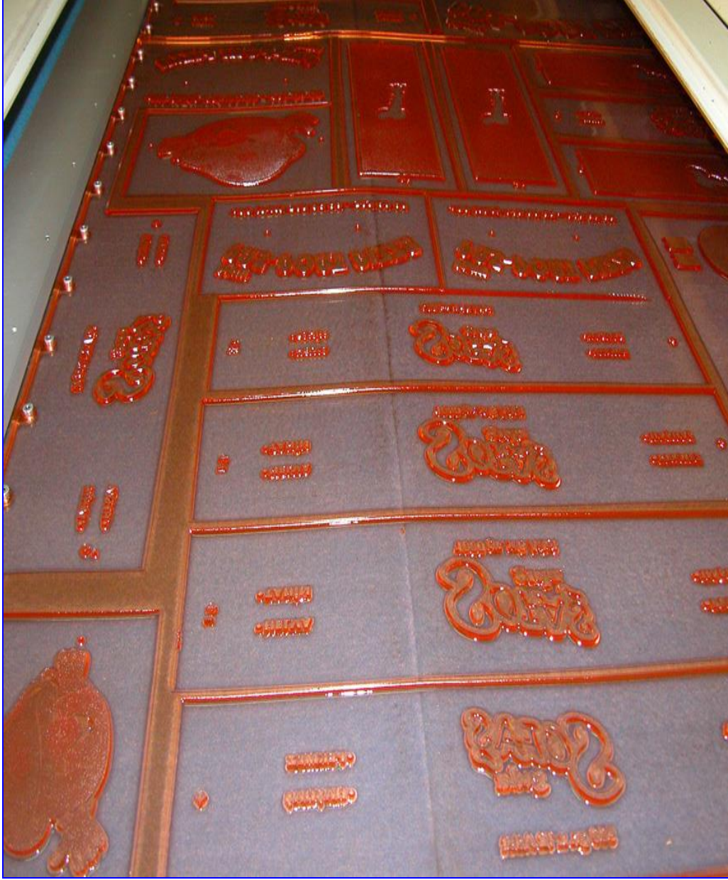
Şekil 3.3: Kalıp yıkamadan sonra indirilmiş bir flekso kalıp görünmektedir. Basan rölyef tabakası ile basmayacak alanların yükseklik farkı belirginleşmiştir.
