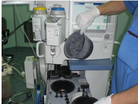
Resim 4.6: Ventilatör diyaframında toplanan suyun boşaltılması
