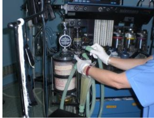
Resim 1.9: Anestezi sistemi solunum devresi hortumlarının monte işlemi
