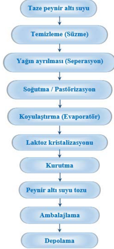
Şema 2.1: Peynir altı suyu tozu üretim iş (proses) akış şeması
