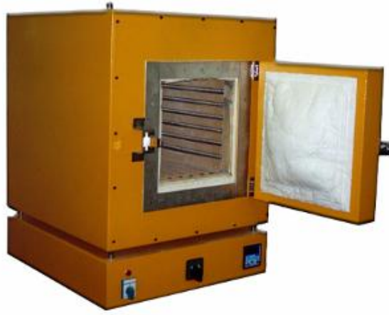
Resim 1.13: Potalı cam eritme fırını
