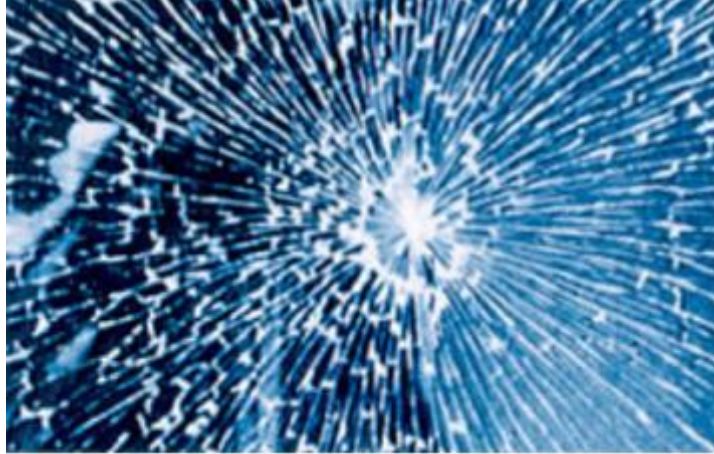
Resim 1.17: Temperleme işlemi uygulanmış kırılmış cam
