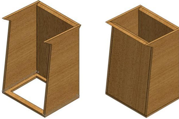
Şekil 3.9: Diğer duvar paneli plakalarının birleştirilmesi
