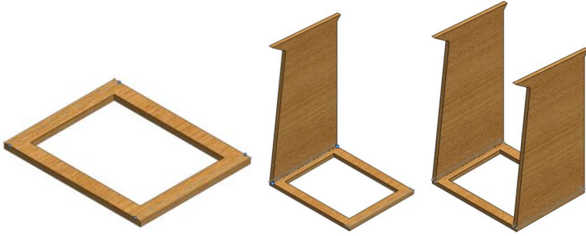
Şekil 3.8: Baca güvertesi ve profil bakış doğrultusundaki duvar paneli plakasının birleştirilmesi
