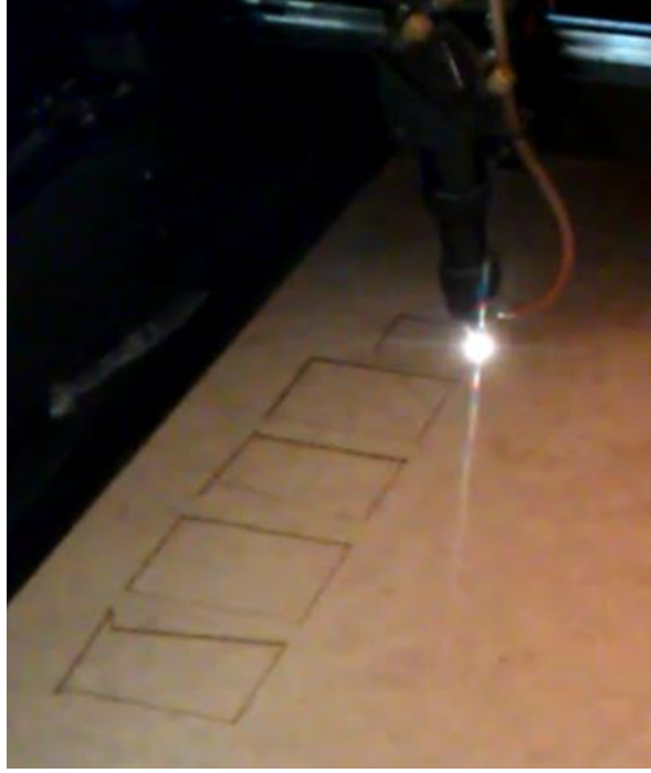
Resim 3.9: CNC lazer kesim makinesi ile kesim
