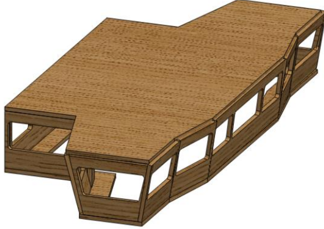
Şekil 1.10: Kaptan köşkünün üç boyutlu katı modeli
