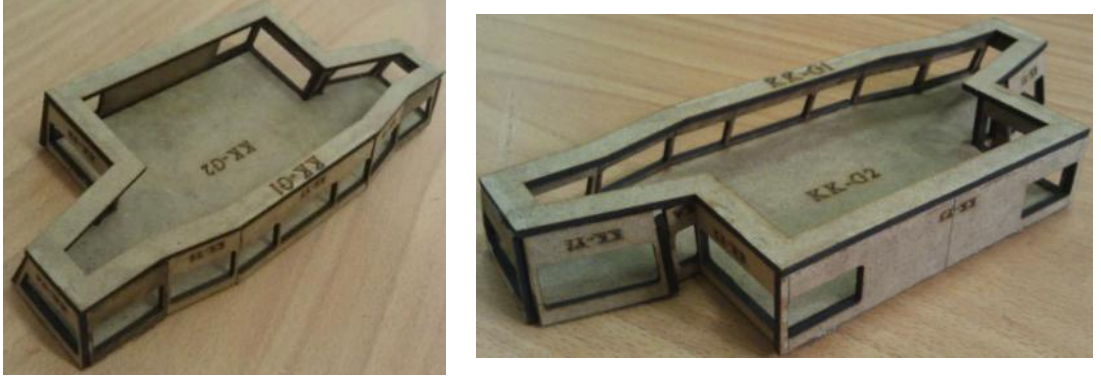
Resim 1.15: Kaptan köşkü açılı yan duvar paneli plakalarının birleştirilmesi
