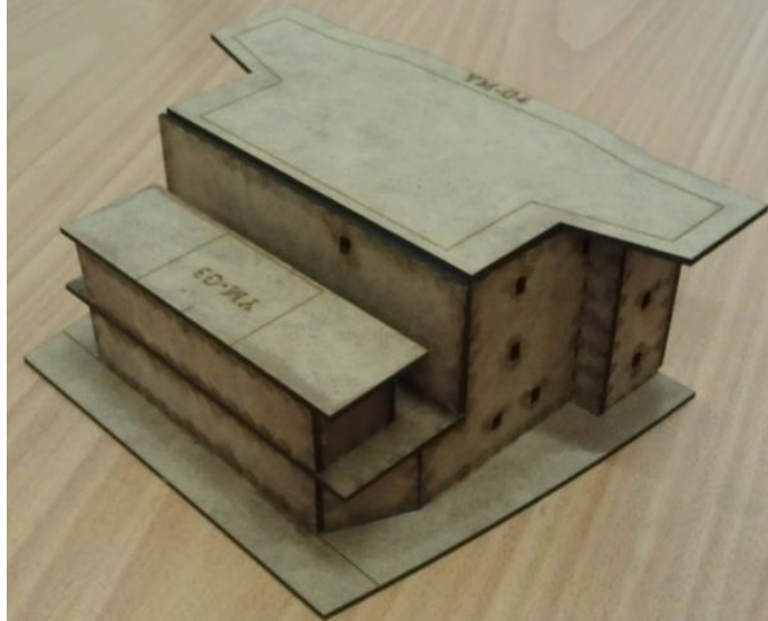
Resim 2.14: Bacanın donatılarının bulunduğu mahal için güverte plakasının birleştirilmesi
