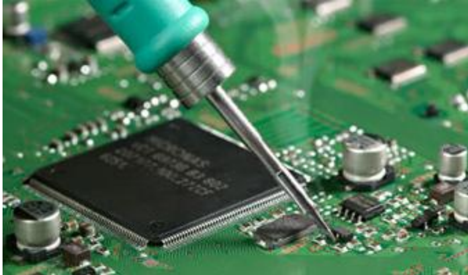
Resim 2.7: SMD transistörün lehimlenmesi
