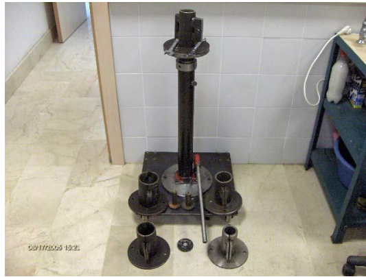
Şekil 1.5: Pistonlu numune itici
