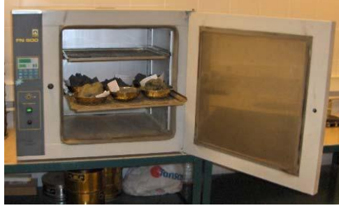
Şekil 2.5: Kurutulmak üzere etüve yerleştirilen zemin numuneleri
