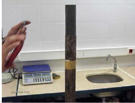
Şekil 1.14: Piston gücüyle çıkarılmış örselenmemiş kil numune
