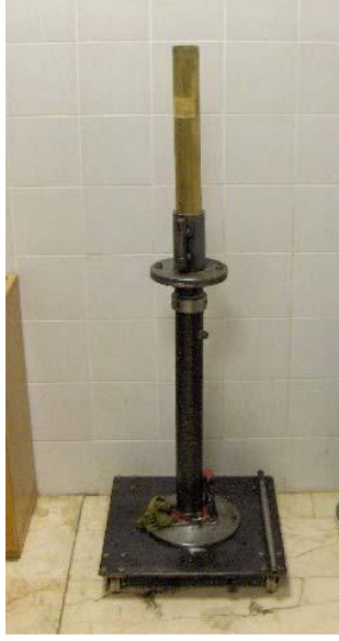
Őekil 1.11: Pistonlu numune iticiye baęlanmış ud tüpü
