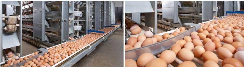
Resim 1.3: Otomatik yumurta toplama sistemleri
