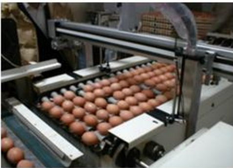
Resim 1.4: Yumurta damgalama makinesi ve damgalanmış yumurta
