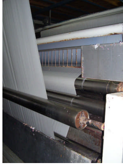
Resim 1.3: Emdirme yöntemine uygun fulard makinesi
