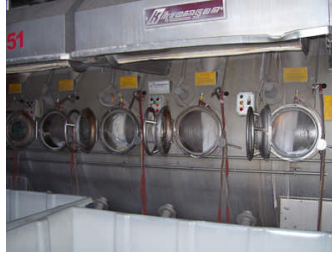
Resim 1.1: Çektirme yöntemine uygun HT boyama makinesi
