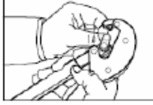
Şekil 3.18: Manşon anahtar ile sıkılarak sağlamlaştırılması
