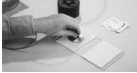
Şekil 3.22: Fiber ucun zımpara pedin üstünde düzleştirilmesi
