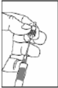
Şekil 3.16: Konnektöre epoxy enjekte edilmesi
