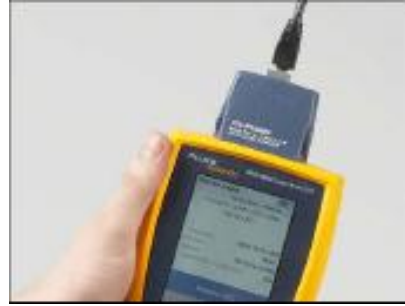
Şekil 2.62: Kablonun test edilmesi
