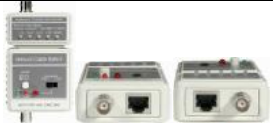
(a) (b) (c) Şekil 2.42: Koaksiyel kablo test cihazı (a) Üstten görünüş (b) Ana Kısım (c) Diğer Kısım
