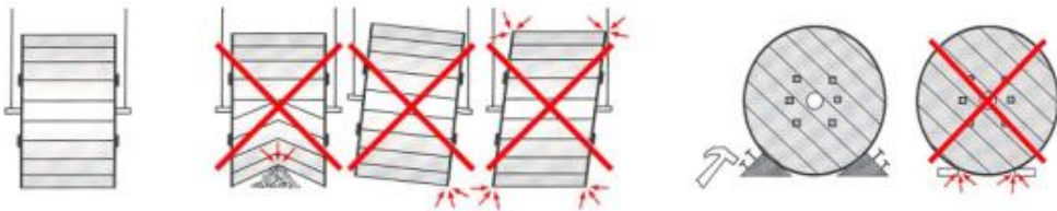
Şekil 2.2: Kablo makarasının döşenme yerine getirilmesi
