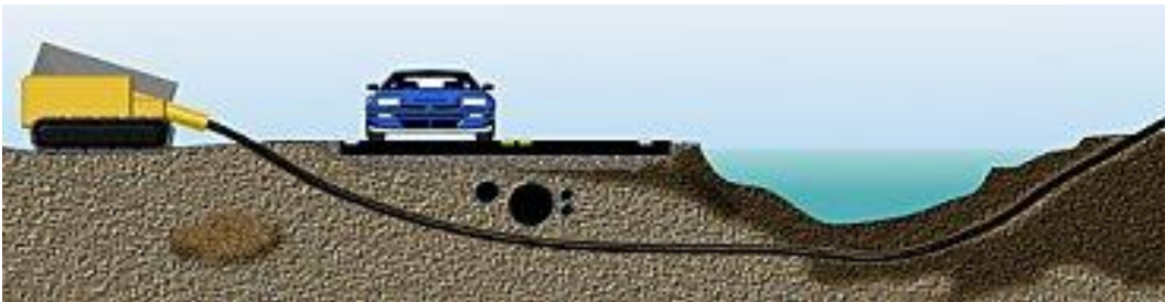
Şekil 2.17: Kablonun sualtı zemin içinden çekilmesi
