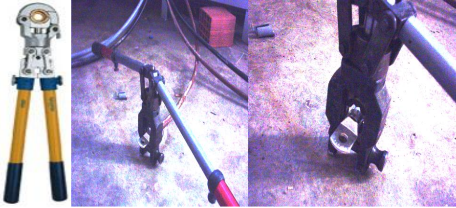
Resim 4.4: Pabucun pens ile sıkılması yöntemi
