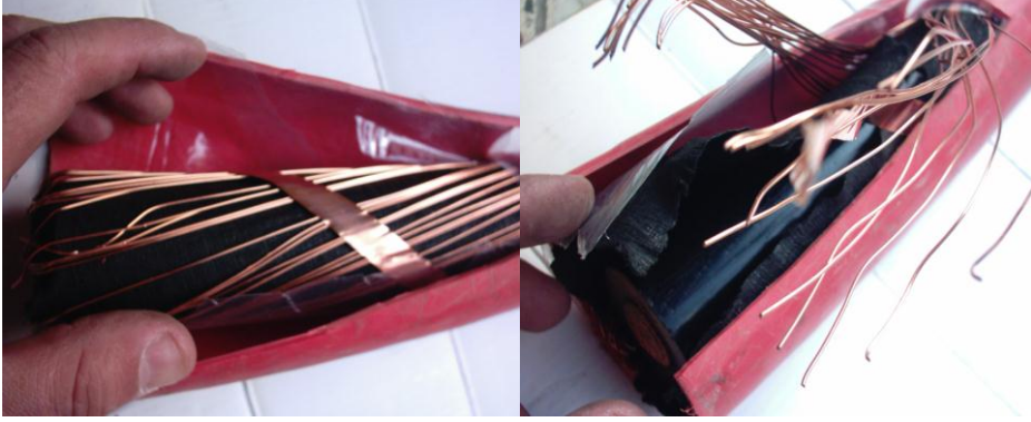
Resim 3.10: YE3SV kablunun bakır şeridi ve telleri, kâğıt koruyucu(siyah) ve yarı iletken tabaka
