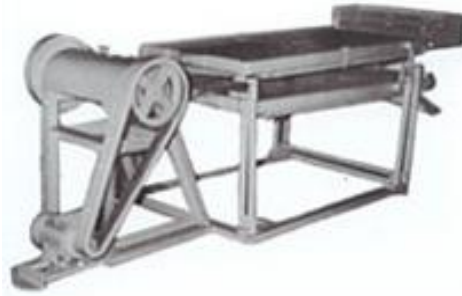
Şekil 1.1: Çöp ayırma eleğinin görünüşü (midilton)
