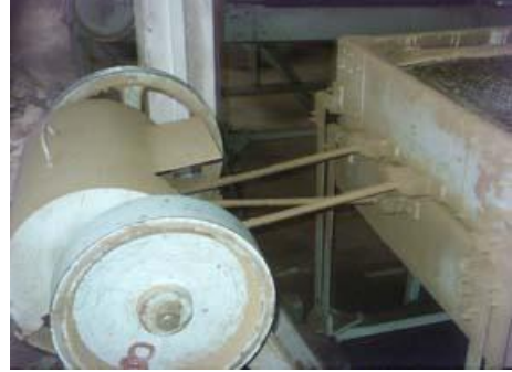
Resim 1.3:Çöp ayırma eleğinin volanı
