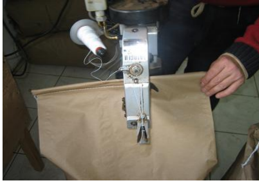
Resim 2.7: Torbanın ağzının dikilmesi
