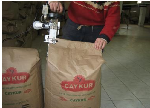
Resim 2.9: Otomatik dikme işlemi
