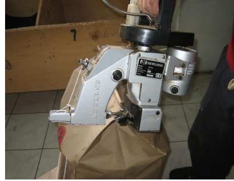
Resim 2.8: Torbanın ağzının dikilmesi
