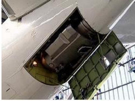
Resim 1.5: Yardımcı güç ünitesinin (APU) uçaktan sökülmesi
