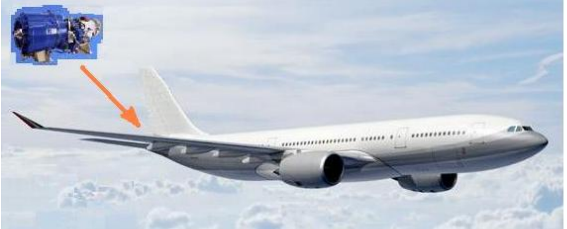
Resim 1.3: Uçağın dikey stabilizerin altında kuyruk konisine yerleştirilmiş APU
