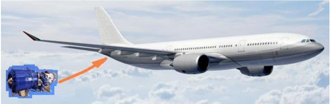
Resim 1.1: Uçağın basınçsız bölmesine ve boylam eksenine dik olarak yerleştirilmiş APU
