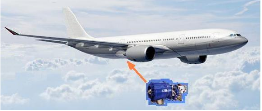
Resim 1.2: Uçağın basınçsız bölümünde iniş takım yuvalarına yerleştirilmiş APU
