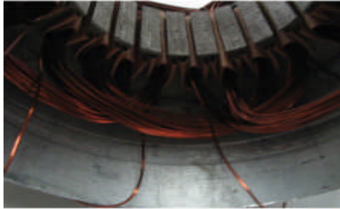
Resim 2.8: Son bobin gurubunun statora yerleştirilmiş hali
