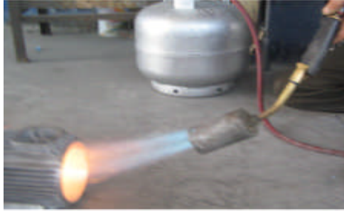
Resim 1.7: Bobin grupları üzerindeki verniğin pürmüz ile eritilmesi
