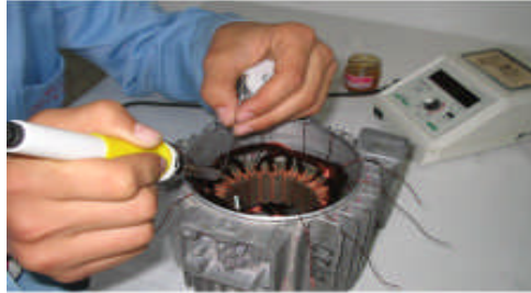
Resim 2.12: Bobin tellerinin havya lehimlenmesi
