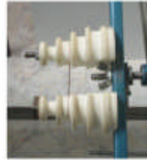
Resim 2.2: Değişken adımli sarım kalıbı
