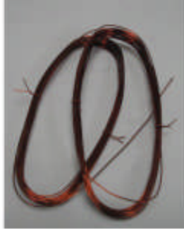
Resim 2.3: Eşit adımlı kalıpta sarılmış ikili bobin grubu
