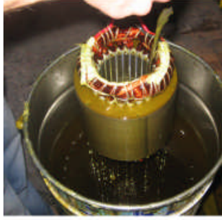
Resim 2.16: Statorun vernik kazanına daldırılarak verniklenmesi
