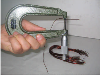
Resim 1.3: Bobin teli çapının mikrometre ve kumpas ile ölçülmesi
