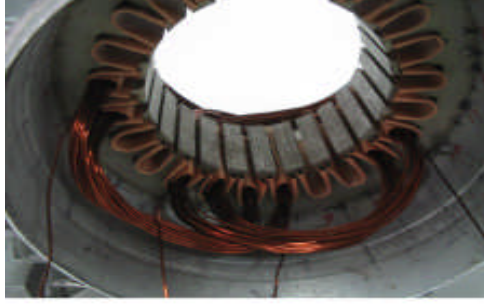
Resim 2.7: İkinci bobin gurubunun statora yerleştirilmesi
