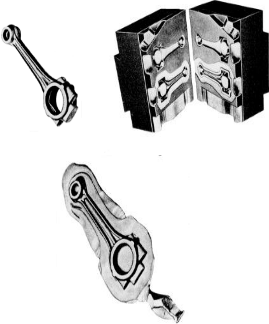
Resim 2.1: Biyel kolu kalıbı ve resmi
