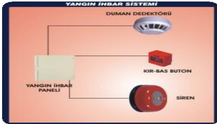
Şekil 2.10: Yangın ihbar sistemi
