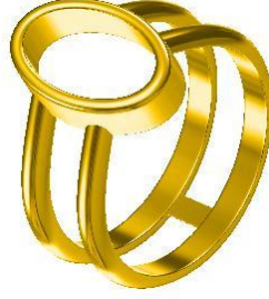
Şekil 2.8: Destek parçasının yüzük koluna kaynatılması
