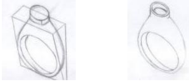
Şekil 3.3: Yardımcı çizgilerin silinerek yüzük formunun oluşturulması
