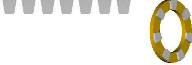
Şekil 2.1: Kontür parçalarının hazırlanarak kaynatılması
