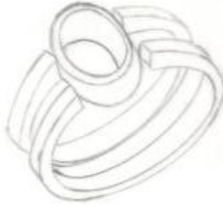
Şekil 1.7:Ölçüye uygun taş yuvasının çizimi
