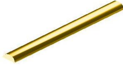
Şekil 2.4: Telin yarım bombe haline getirilmesi
