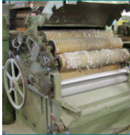
Resim 3.1: Hallaç makinesinde ayarlar
