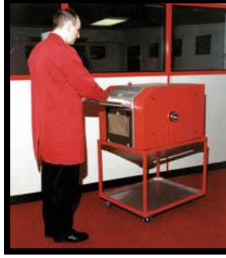
Resim 2.7: Shirley cihazına elyaf besleme
