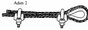
İkinci tespit civatasının tatbiki : ikinci civata halkaya mümkün olduğunca yakın yerleştirilir. Somunlar dönmeyecek derecede sıkılır.
