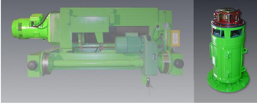
Resim 3.1: Vinç arabası kaldırma motoru freni
