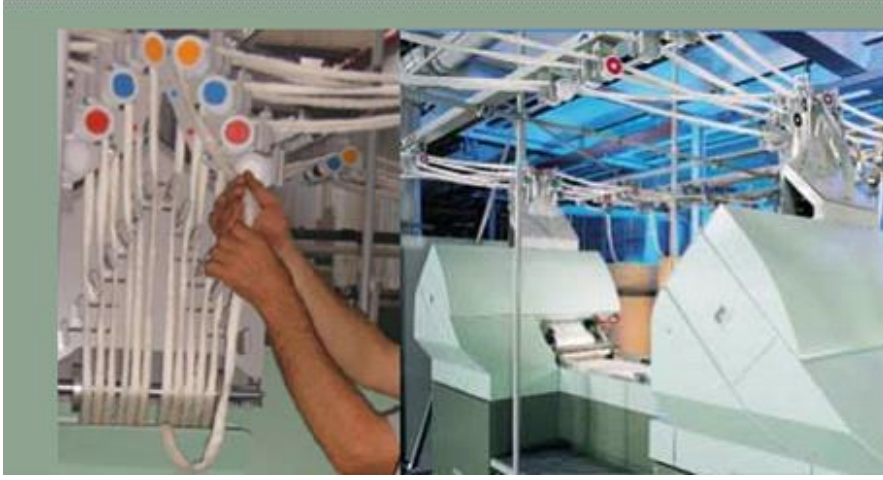
Resim 2.5: Makinede kopuk şerit bağlama ve üretim
