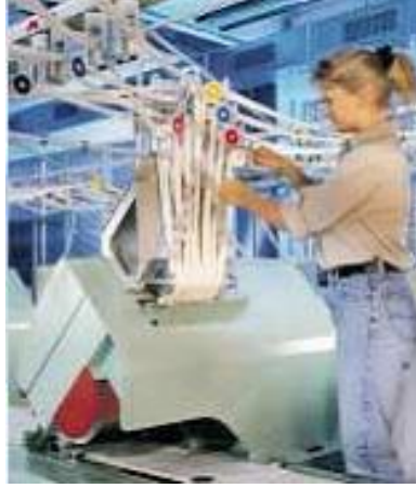
Resim1.8: Çađlıktaki uçuntuların temizlenmesi
