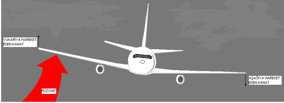
Resim 2.8: Kanat altından ani rüzgar alıp yatay kararlılığın bozulması
