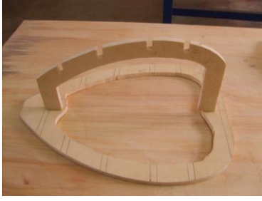
Resim 1.4: Boy kayıtın markalanması ve hazırlanması Şekil 1.2 : Boy kayıtın markalanması
