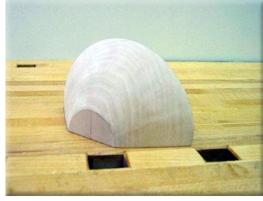
Resim 1.10: Ön takozun net ölçü ve biçimine getirilmiş hâli
