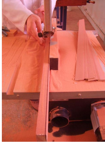
Resim 2.8: Dilim kalınlıklarının kesilmesi
