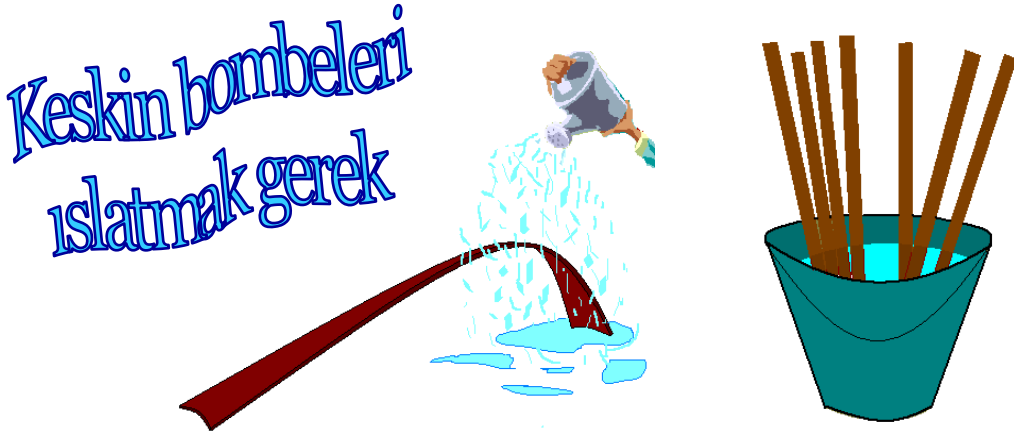
Şekil 2.1: Sert ağaçtan yapılmış dilimler bir gün önceden ıslatılmalıdır.
