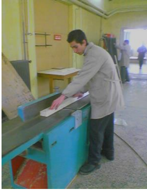
Resim 2.6: Planya makinesinde yüz açma
