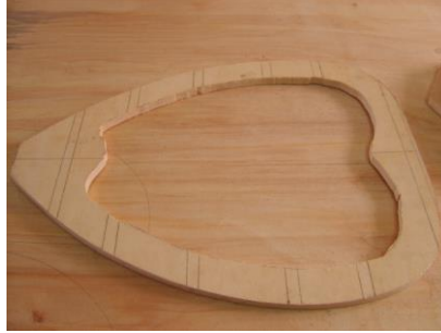
Resim 1.3: Kalıp alt parçasının net ölçüsüne getirilmiş hâli
