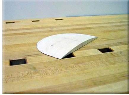
Resim 1.8: Arka takozun net ölçü ve biçimine getirilmiş hâli
