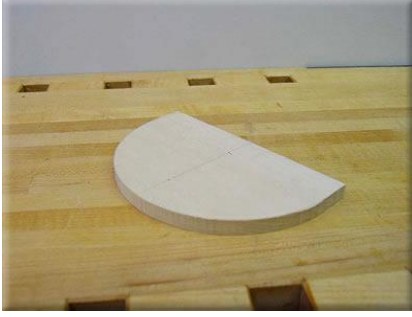
Resim 1.7: Arka takozun şerit testere makinesinde kesilmiş hâli
