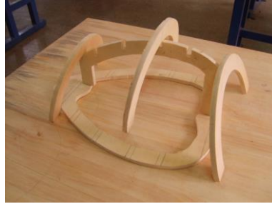
Resim 1.5: Yan kayıtların dilimler hâlinde markalanarak hazırlanması
