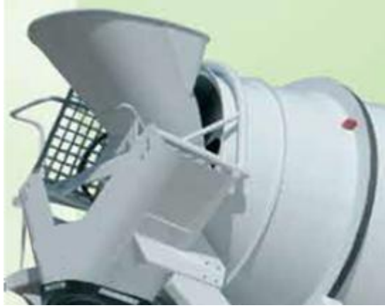
Resim 3.8: Besleme oluğunun transmikslerdeki yeri
