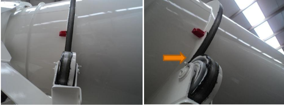
Resim 5.10: Kazan ringinin kontrolü ve greslenmesi
