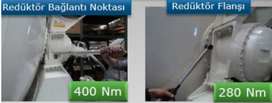
Resim 5.4: Redüktör bağlantı noktaları cıvatalarının kontrolü
