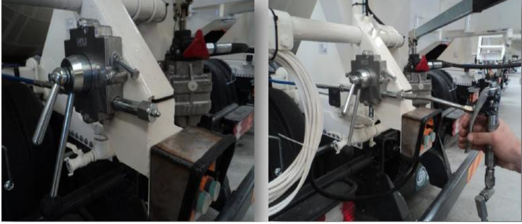
Resim 5.9: Kontrol kablosu kontrolü ve greslenmesi
