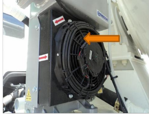
Resim 5.14: Yağ soğutucu pervane kontrolü
