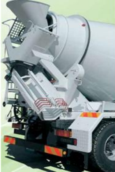
Resim 3.2: Oluklarının transmikserdeki yeri
