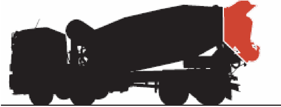
Şekil 3.2: Oluklarının makinedeki yeri
