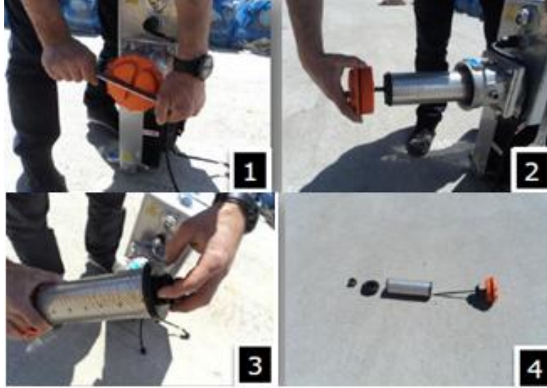
Resim 5.7: Hidrolik filtrenin deęiřtirilmesi
