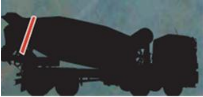
Şekil 2.4: Kazan ringinin transmikslerde konumu
