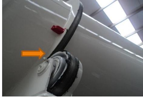
Resim 2.10: Kazan ringinin greslenmesi
