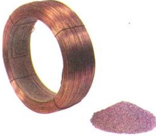
Resim 1.11: Tozaltı kaynağında kullanılan kaynak teli ve tozu
