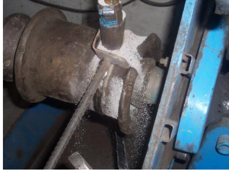
Resim 1.3: Tozun kaynak esnasında kullanılması ve kaynağa etkileri
