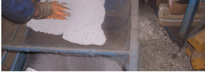
Resim 1.2: Tozaltı kaynağında kullanılan tozlar
