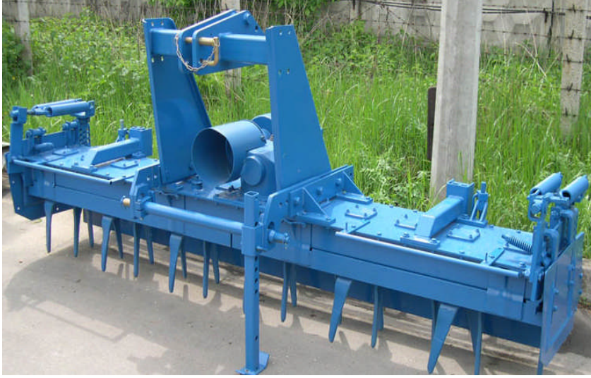
Resim 2.7: Traktör kuyruk mili ile çalışan tırmık
