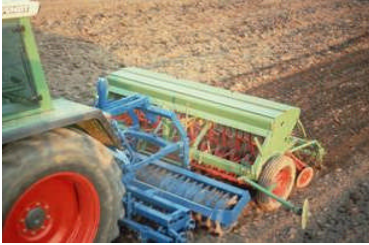
Resim 4.4: Yaylı trmk, diskli trmk ve ekim makinesi kombinasyonu
