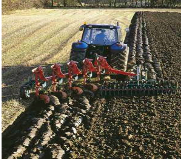
Resim 4.2: Döner kulaklı pulluk merdane kombinasyonu
