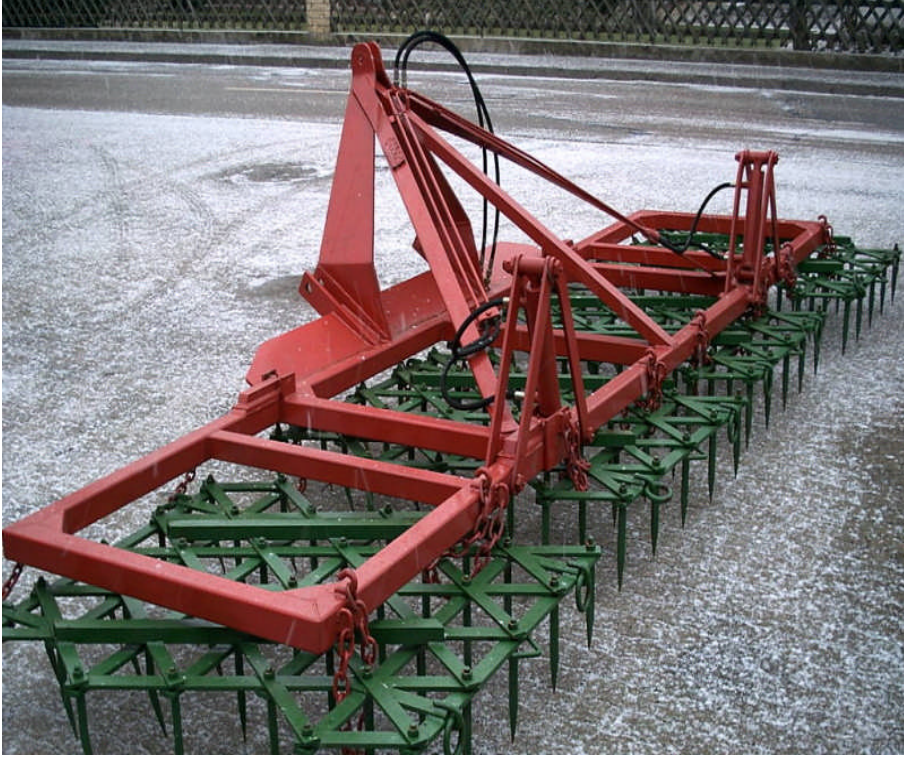
Resim 2.6: İş genişliği artırılmış bir tırmık
