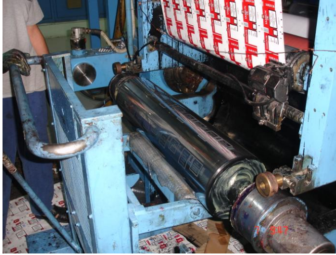
Şekil 1. 1: Şaftlı silindirin çıkartılması
