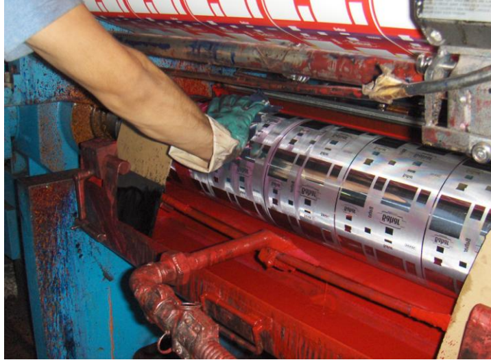
Şekil 1. 3: Kalıp silindirinin temizlenmesi
