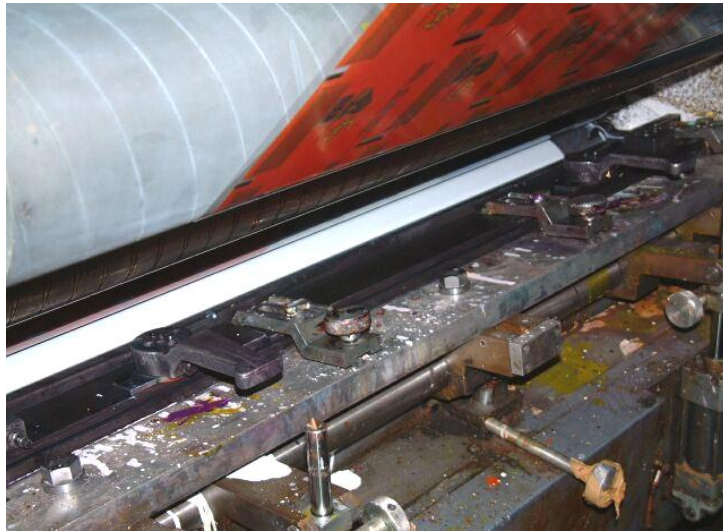
Şekil 1.3: Raklenin baskı makinesinde çalışır hali
