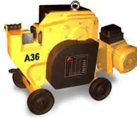
Resim1.4: Makas tezgâhları (elektrik motoru ile çalışan makaslar)
