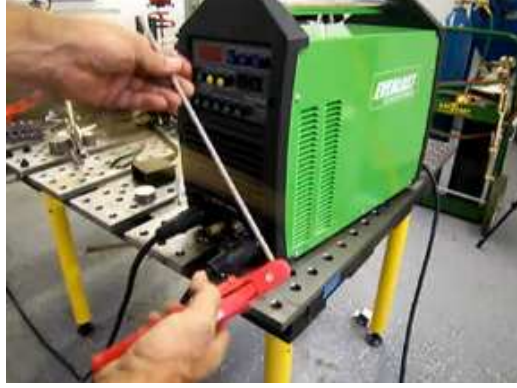
Fotoğraf 1.11: Pense elektrot kavrıtma
