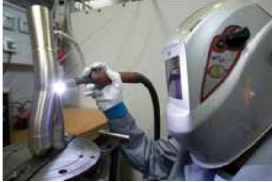
Fotoğraf 1.1: Gaz altı (TIG) kaynağının yapılışı
