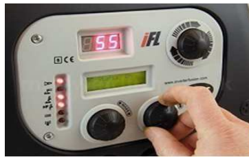
Fotoğraf 1.9: TIG kaynak makinesinin ayar mekanizması
