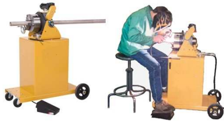
Fotoğraf 1.15: Boru pozisyoneri ve çalışma
