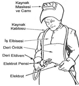
Resim 1.4: Kaynakçının kullandığı elemanlardan bazıları
