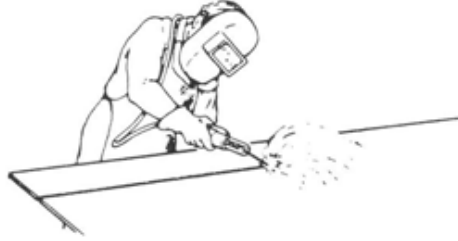
Resim 1.8: İş parçasının elektrot kullanılarak kesilmesi
