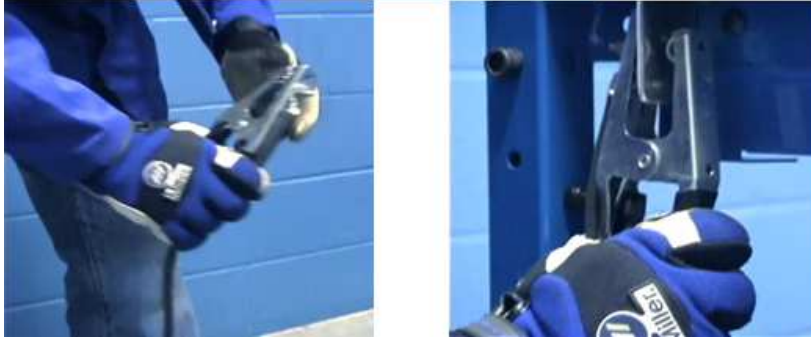
Fotoğraf 1.12: Şase ve şasenin kaynak masasına bağlanması
