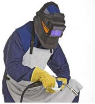
Fotoğraf 1.20: Kaynak yapımı sırasında solar hücrelerinden aldığı güç ile koyulaşmış diğer zamanlarda görüşü kolaylaştırmak için açık renk alan camlara sahip kaynak maskesi
