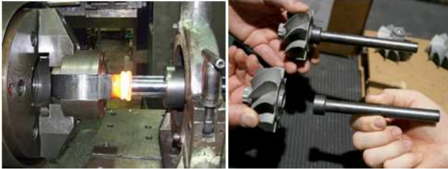
Fotoğraf 1.2: Sürtünme kaynağının yapılışı ve iş parçası
