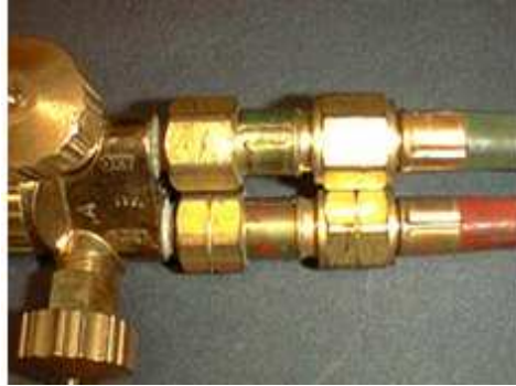
Fotoğraf 2.2: Üfleç ve hortumların arasına bağlanmış kuru güvenlikler
