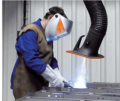
Fotoğraf 1.19: Kaynak aspiratörü ile çalışma
