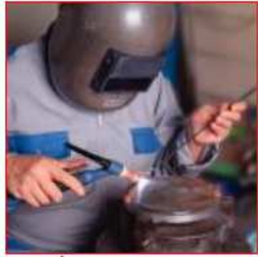
Fotoğraf 3.2: TİG kaynağın yapılışı
