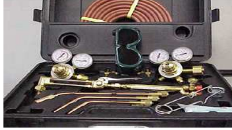
Fotoğraf 2.3: Üfleç takımı ve koruyucu metal kutusu
