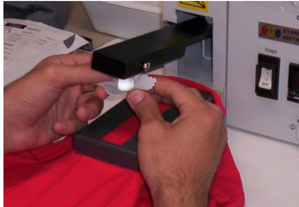
Resim 2.3: Sürtme bezinin sürtme ucuna takılışı
