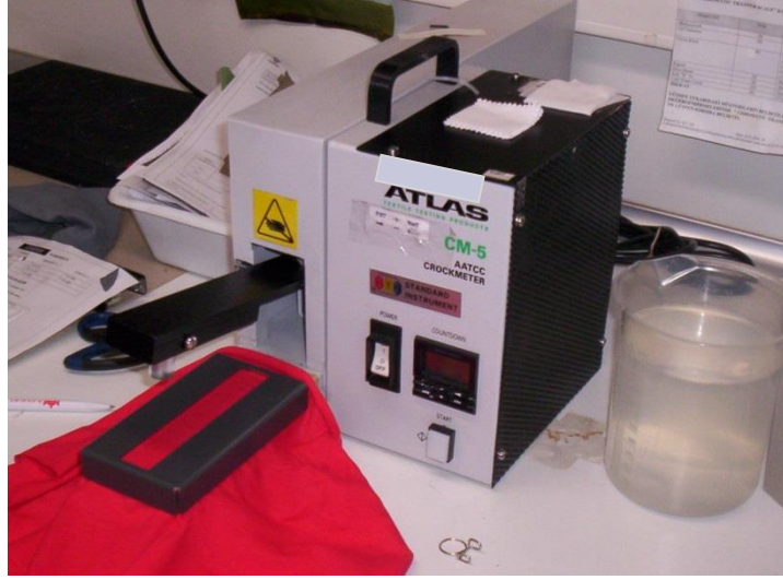
Resim 2.2: Sürtme haslıđı test cihazı (crockmeter)
