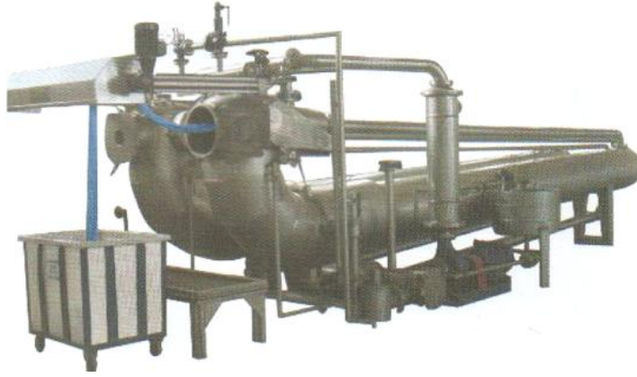
Resim 2.2: Makineye kumaşın yüklendiği bölüm
