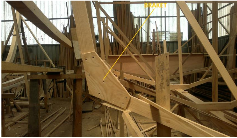
Resim 2.2: Braket ve posta bağlantıları
