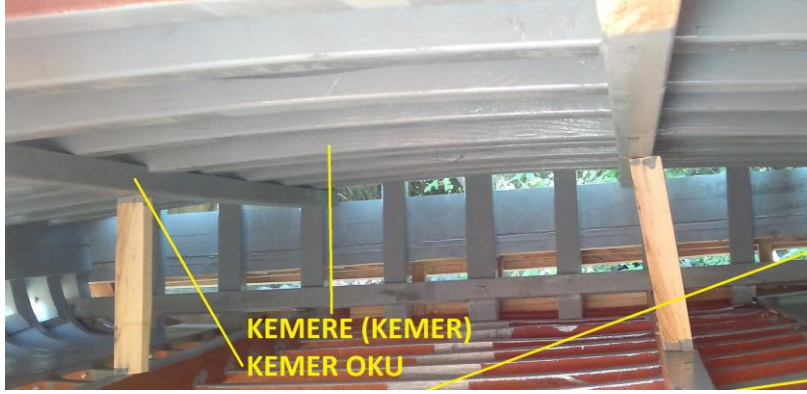
Resim 2.7: Ahşap teknede kemer ve altını destekleyen boy bağı kemere oku
