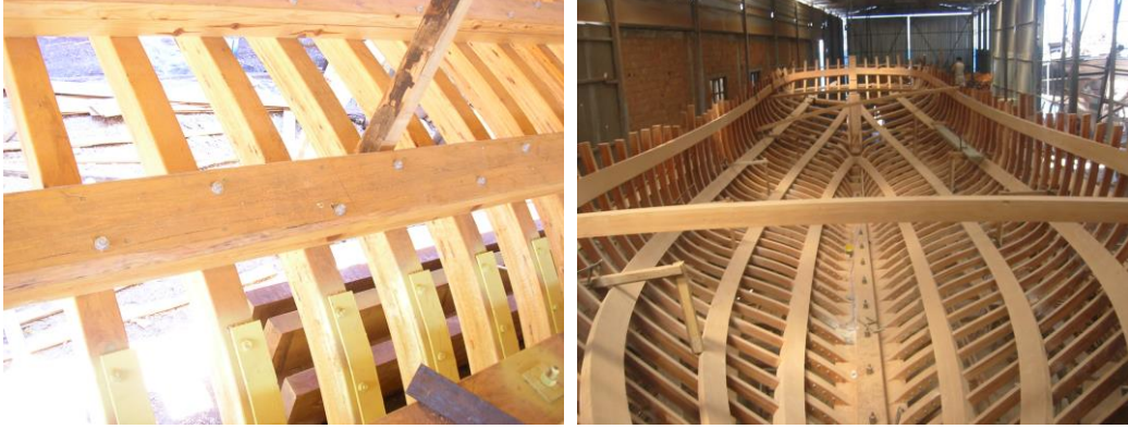
Resim 2.3: Posta üstüne ıstralya bağlantısı
