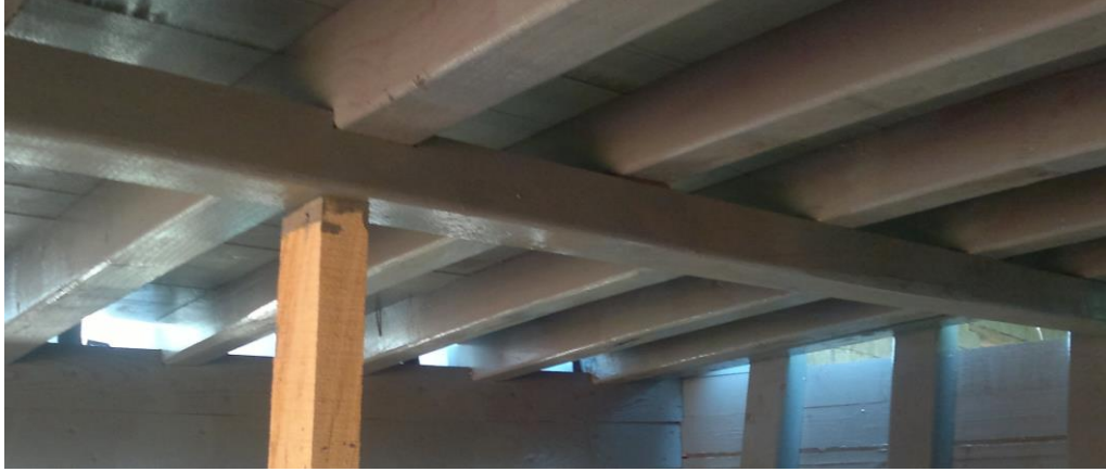
Resim 2.8: Yapım aşamasında bir ahşap teknede destek boy bağı kemere oku
