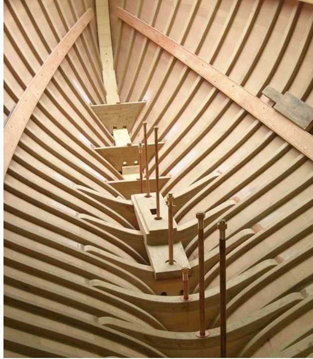
Resim 1.2: İç Omurga bağlantı kesiti
