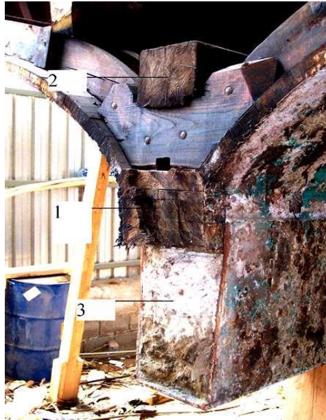
Resim 1.4: Omurga-iç omurga-salma bağlantı kesiti
