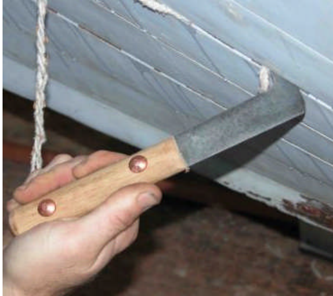
Resim 1.2: Kalafatlama tırnığının kullanılışı-1
