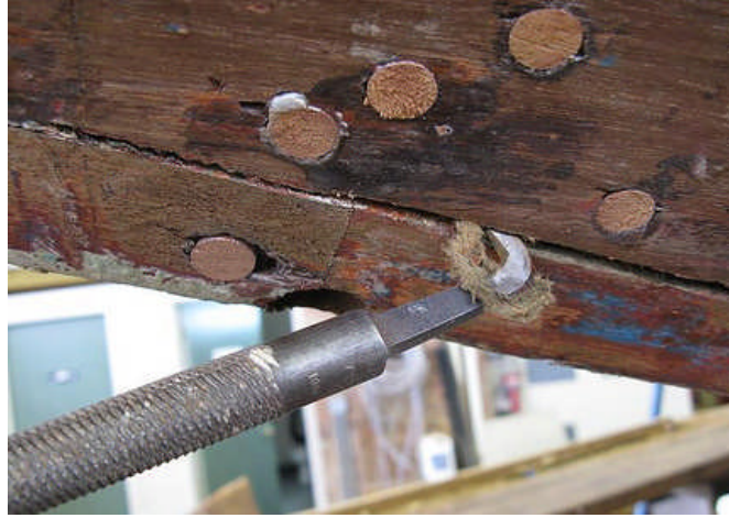
Resim 1.3: Kalafatlama tırnığının kullanılışı-2
