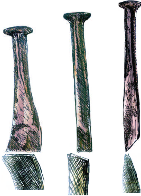
Resim 1.6: Oluk ağızlı kalafatlama demiri örnekleri
