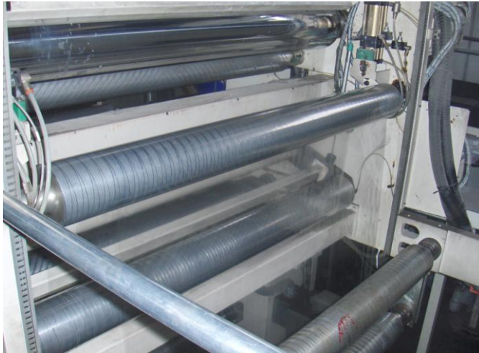
Resim 2.5: Dansör merdane ve potansiyometre
