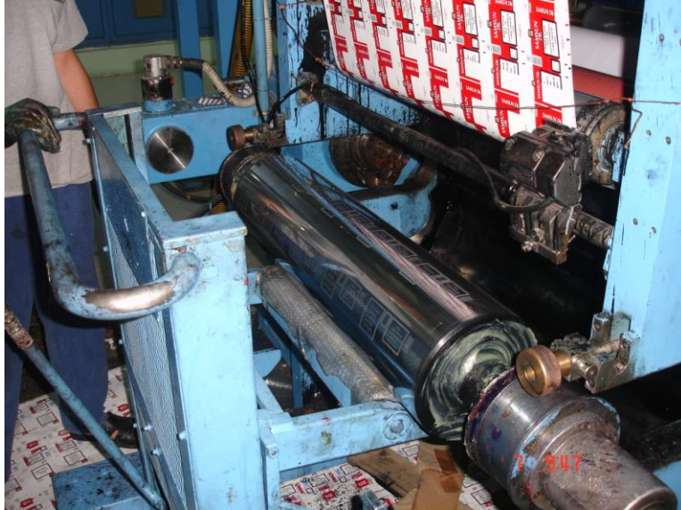
Resim 2.1. :Şaftlı kalıp silindirinin takılması
