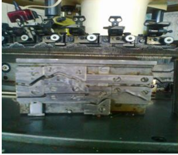
Resim 1.4: Vanize süprem örgünün çelik dizilimi
