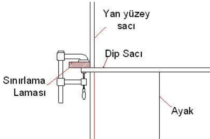
Şekil 2.2: Dip sacı kenarına işkence ile sınırlayıcı sabitlenmesi
