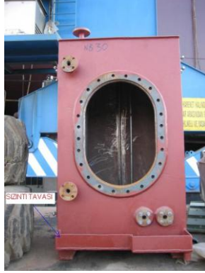
Resim 1.3: Tank üzerine monte edilmiş sızıntı tavası
