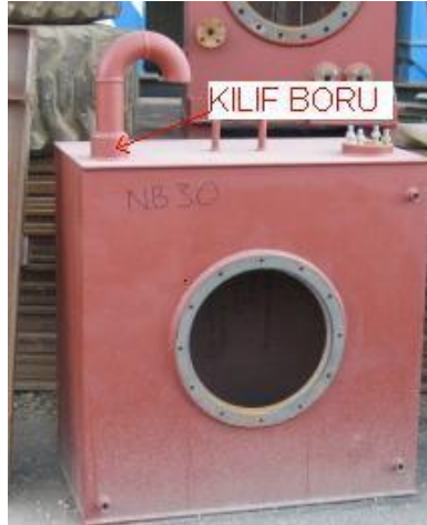
Resim 1.4: Kılıf boru uygulaması
