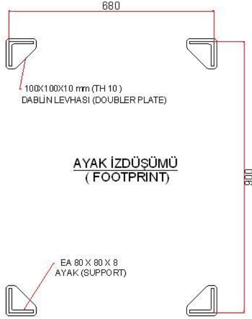
Şekil 2.4: Tank ayak iz düşümü detayı
