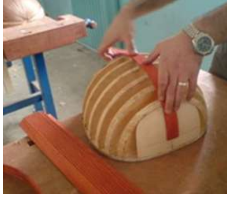
Resim 2.2: Dilimlerin ¼t¼den kıvrıldıktan sonra kalıba g¼re alıřtırılması
