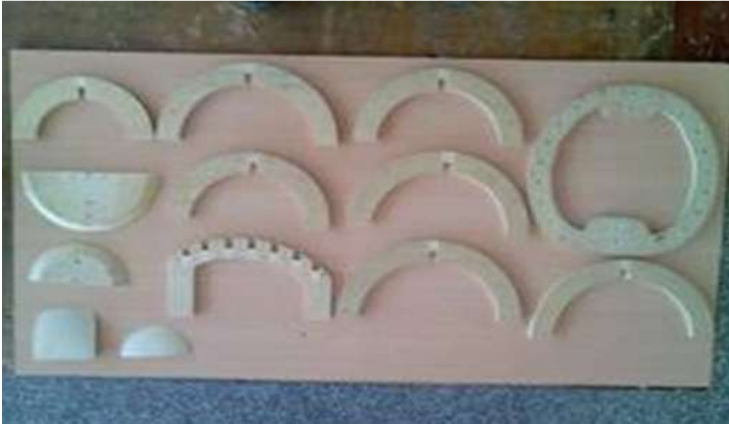
Resim 1.9: Şablona göre çıkarılmış kalıp taban ve dilim parçaları
