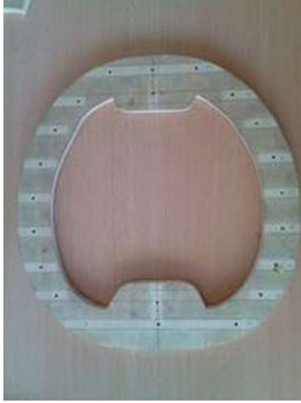
Resim 1.6: Ses tablasına göre ilk kalıbın (taban kısmı) çıkartılmış hâli
