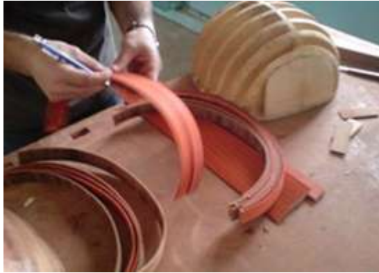
Resim 2.15: Dilimlerin kalıba göre kıvrılıp hazırlanmış hâli
