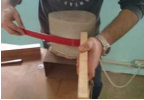
Resim 2.13: Dilimlerin uç kısmının takoz yardımıyla kıvrılması
