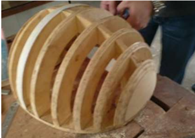
Resim 2.10: Dilim genişliklerinin hesap edilmesi
