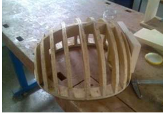
Resim 1.15: Takozun genişlik ve boyunun kalıba göre ayarlanması
