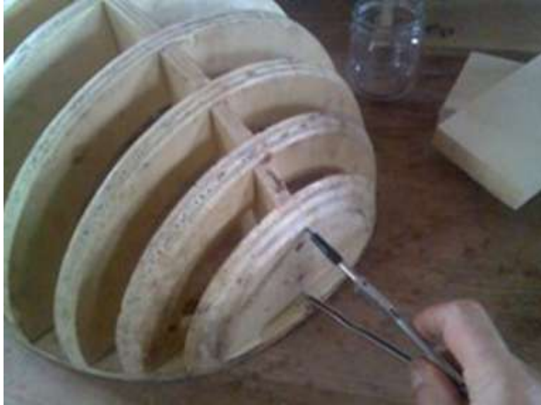
Resim 1.14: Ön takoz yapmak için pergelle ölçünün alınması
