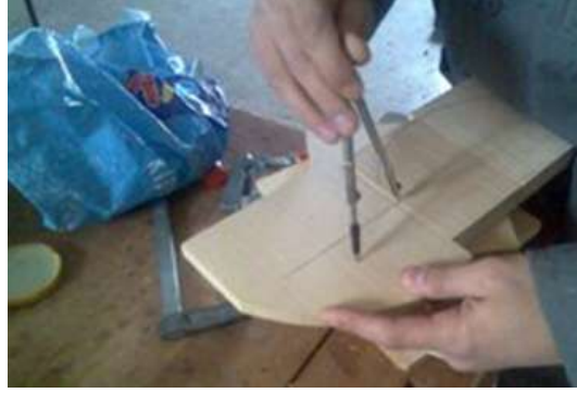
Resim 1.16: Ölçüleri ayarlanmış takozun pergelle kalıba göre markalanması
