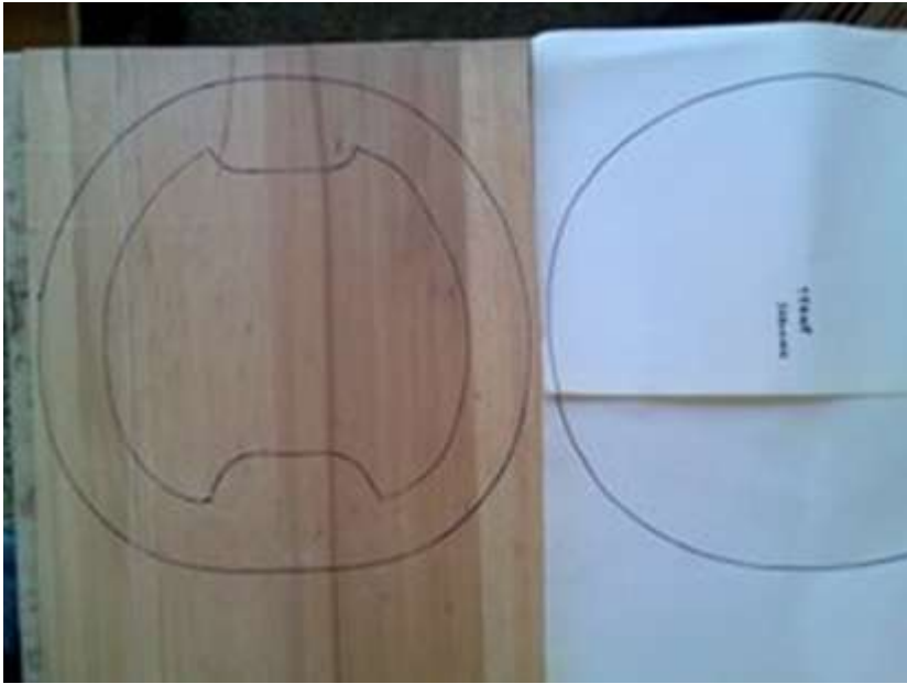
Resim 1.5: Şablonun kalıbı çıkarılacak malzemeye aktarılması
