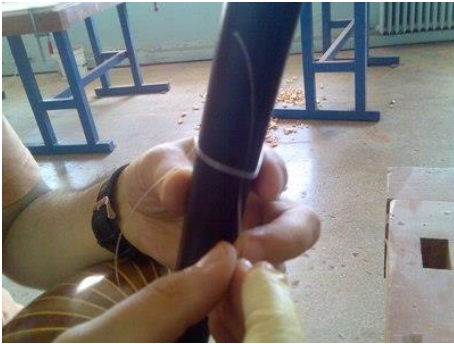
Resim 2.20: Kanaldan misinanın geçirilmesi
