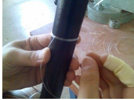
Resim 2.19: 2. düğüm için kanaldan geçirilmesi
