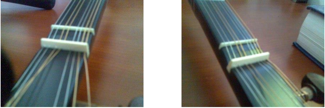
Resim 3.7: Tellerin köprüden geçirilmesi
