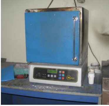
Resim 3.4: Manşetin döküm fırınında ısıtılması
