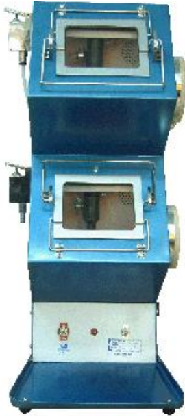
Resim 4.3: Çift kabinli kumlama makinesi
