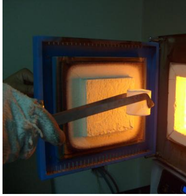
Resim 3.5: Manşetin döküm fırınından alınması
