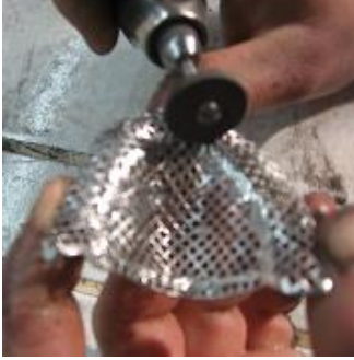
Resim 8.4: Metal yüzeyin düzgünleştirilmesi
