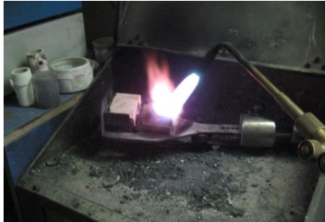
Resim 2.2: Şalome ile metalin eritilmesi
