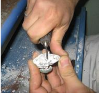
Resim 5.6: İnce aşındırıcı ile metal iskeletin temizlenmesi
