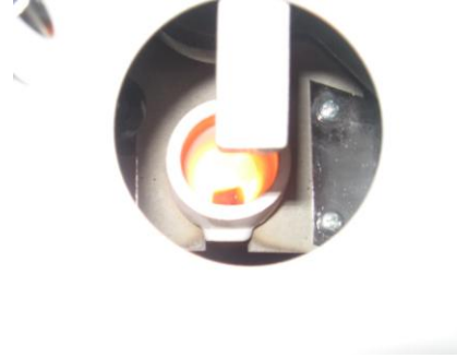
Resim 2.7: İndüksiyon akımlı döküm fırınında döküm elde etme
