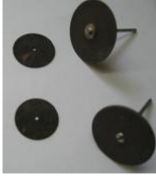
Resim 5.1: Aşındırma işleminde kullanılan separeler
