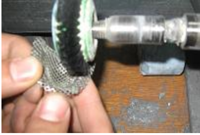
Resim 8.8: Metal yüzeyin parlatılması
