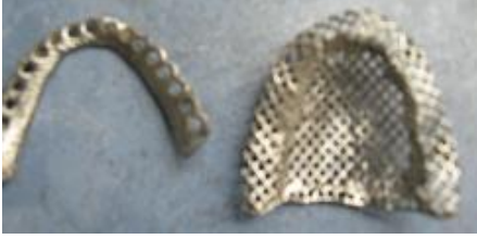
Resim 6.7: Oksitlerinden arındırılmış metal
