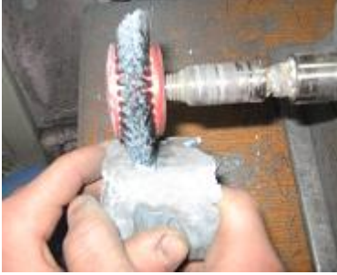
Resim 8.7: Cila pastasının fırçaya Sürülmesi
