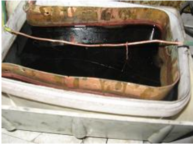
Resim 7.8: Metalin asit içinde bekletilmesi
