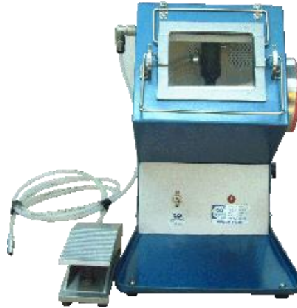
Resim 4.4: Tek kabinli kumlama makinesi
