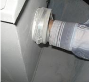
Resim 4.15: Hava ile kum karışımına metali tutmak
