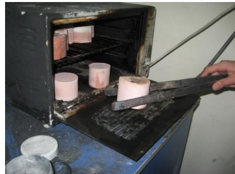
Resim 2.3: Ön ısıtma fırınından manşet alırken
