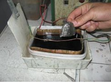
Resim 7.10: Metalin elektrolizden çıkarılması
