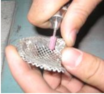
Resim 8.5: Metaldeki separe izlerinin, sivri lastikle yok edilmesi
