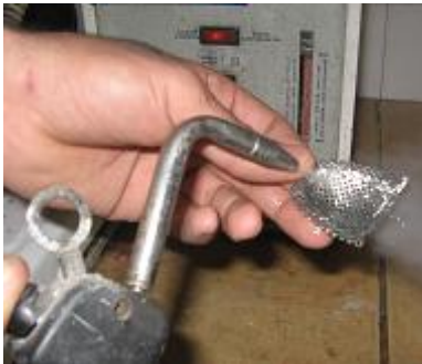
Resim 8.12: Metalin basınçlı buhar ile temizlenmesi
