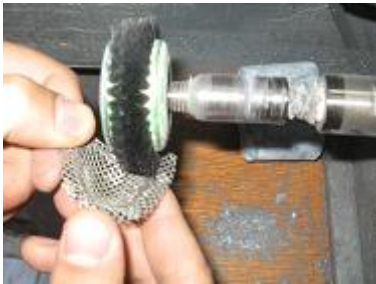
Resim 8.9: Metalin cila motorunda fırçalanması
