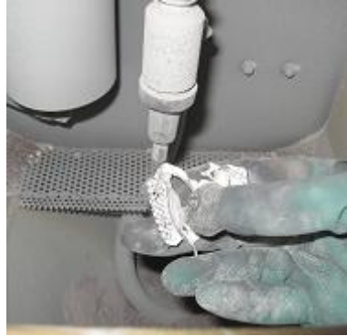
Resim4.13: Metali kum ve hava karışımına tutmak
