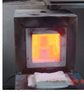
Resim 2.1: Elektrikle ısıtılan fırın
