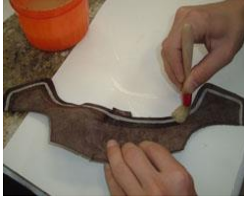
Resim 2.6: Takviye bandı üzerine yapıştırıcı sürme
