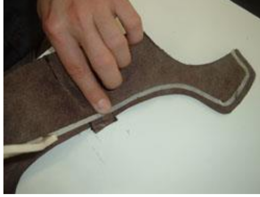
Resim 2.5: Takviye bandı yerleştirme
