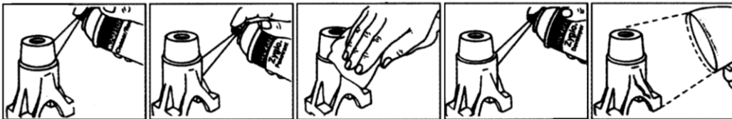
Şekil 1.2: Ultraviyole ışınları altında sıvı emdirerek yapılan muayenenin aşamaları
