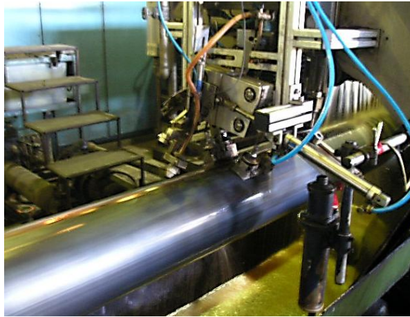
Resim 2.1: Ultrasonik laminasyon cihazı ile boru kontrol
