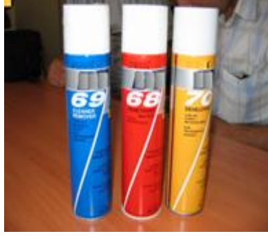
Resim 1.1: Penetran testinde kullanılan soldan sağa doğru temizleyici sprej, penetran sprej ve geliştirici sprej
