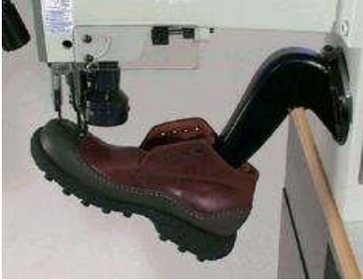
Resim 3.7: Ayakkabının makineye yerleştirilmesi
