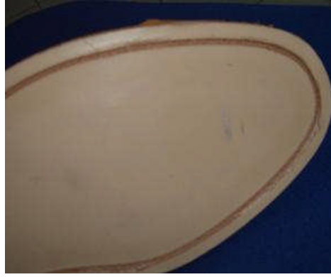
Resim 2.2: Kösele tabana kanal açma makinesi ile açılmış fora dikiş kanalı
