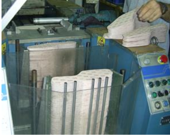
Resim 3.1: Yapıştırıcı sürme makinesine salpaların yerleştirilmesi
