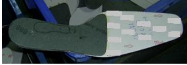
Resim 3.7: Birleştirme işlemleri bitmiş olan taban astarı
