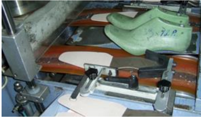
Resim 3.8: Kampre verme işlemi için yerleştirilen parçalar
