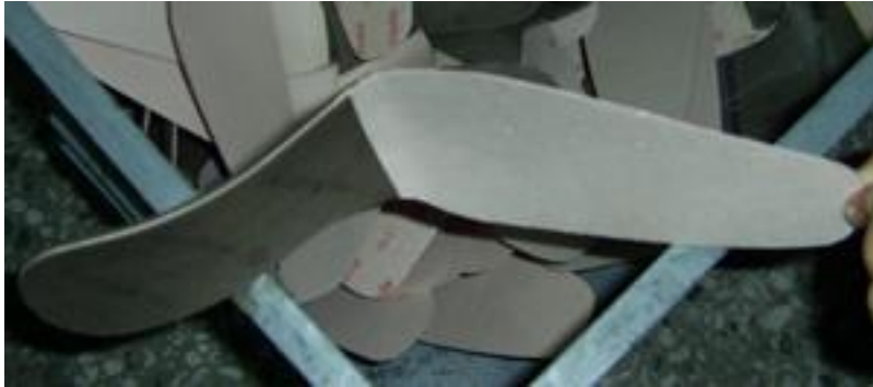
Resim 3.10: řekillendirme sonrası taban astarının aldıđı řekil
