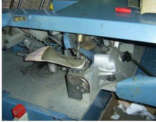
Resim 3.11: Freze makinesinde alt fiber kısmının düzeltilmesi
