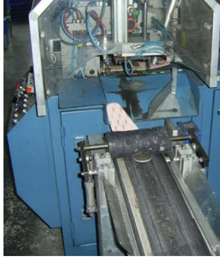
Resim 3.6: Taban astarının sıkıştırma sisteminden geçişi
