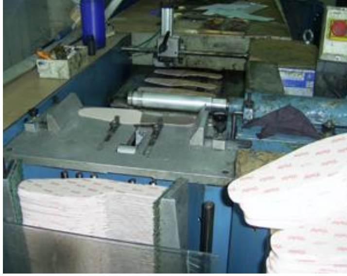
Resim 3.2: Yapıştırıcı sürme işlemi
