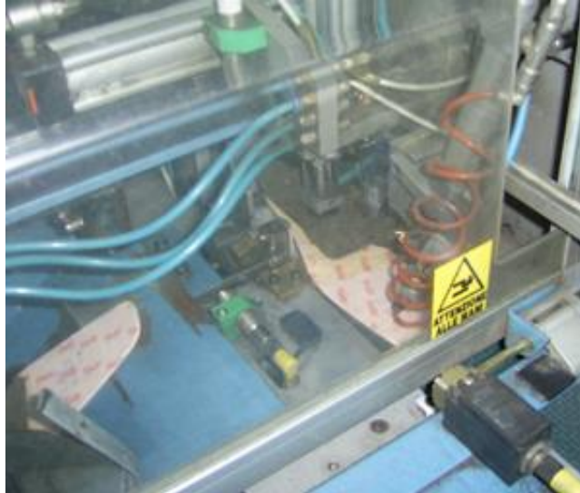
Resim 3.5: Makinede alt fiber ile salpanın birleştirilmesi
