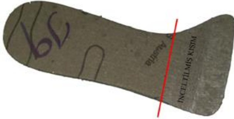
Resim 2.3: Ön alma makinesinde inceltilmiş alt fiber
